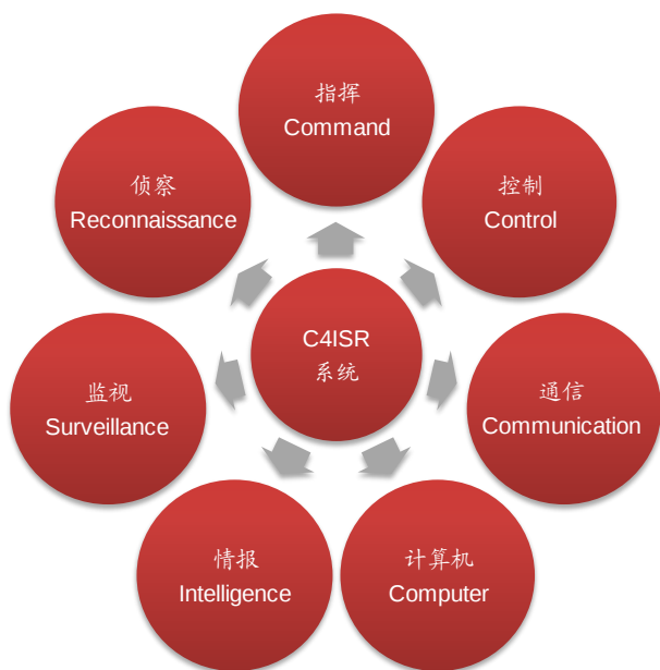
图表 16：C4ISR 系统由指挥、控制、通信、计算机、情报、侦察等子系统构成
